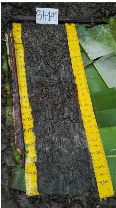
Figura 21 Perfil tomado con barreno de aleta (Fototeca IGAC, 2015)
