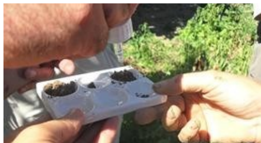
Figura 11 Reacción al HCl para determinar presencia de carbonatos de calcio (Fototeca IGAC, 2016)
