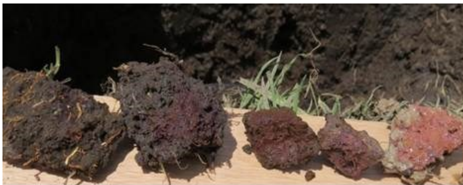
Figura 12 Reacción a \alpha - \alpha Dipyridil (Fototeca IGAC, 2016)
