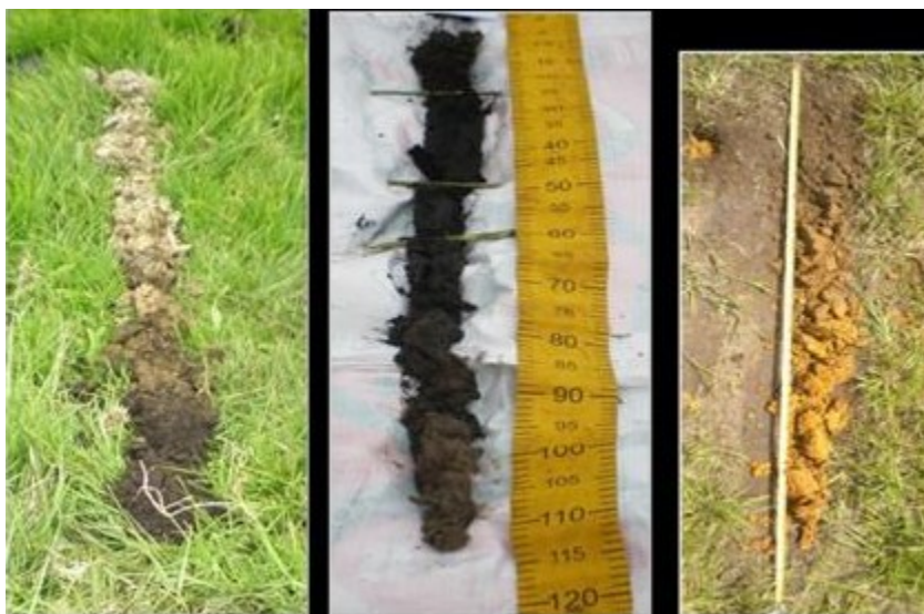
Figura 13 Observaciones de comprobación (barrenajes) (Fototeca IGAC, 2016)
