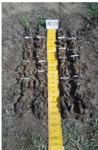
Figura 19 Separación de horizontes en perfil tomado con barreno (Fototeca IGAC, 2015)
