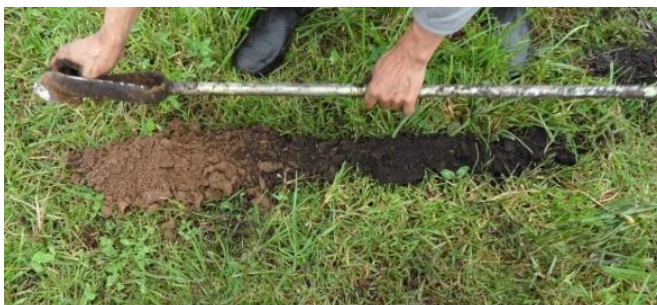
Figura 5 Extracción de suelo con barreno Fototeca IGAC, 2016)
