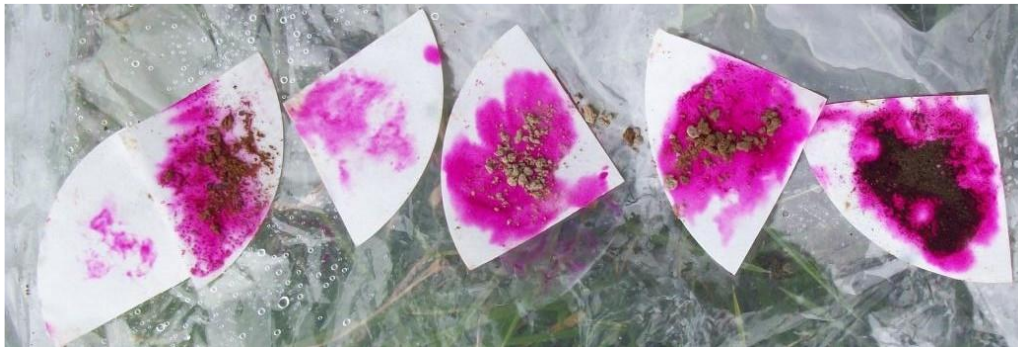
Figura 10 Reacción al Fluoruro de Sodio que muestra la evidencia de acumulación de cenizas volcánicas. Reacción en campo (Fototeca IGAC, 2016)
