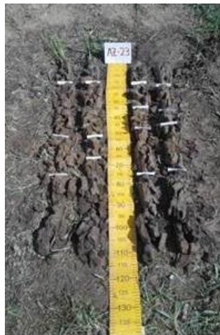
Figura 19 Separación de horizontes en perfil tomado con barreno (Fototeca IGAC, 2015)
