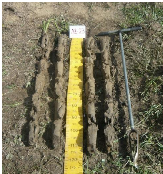
Figura 18 Muestras tomadas con barreno (Fototeca IGAC, 2015)
