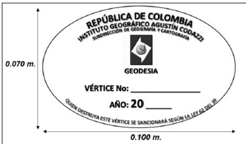
Figura 4. Placa de aluminio utilizada para la identificación de vértices geodésicos.
